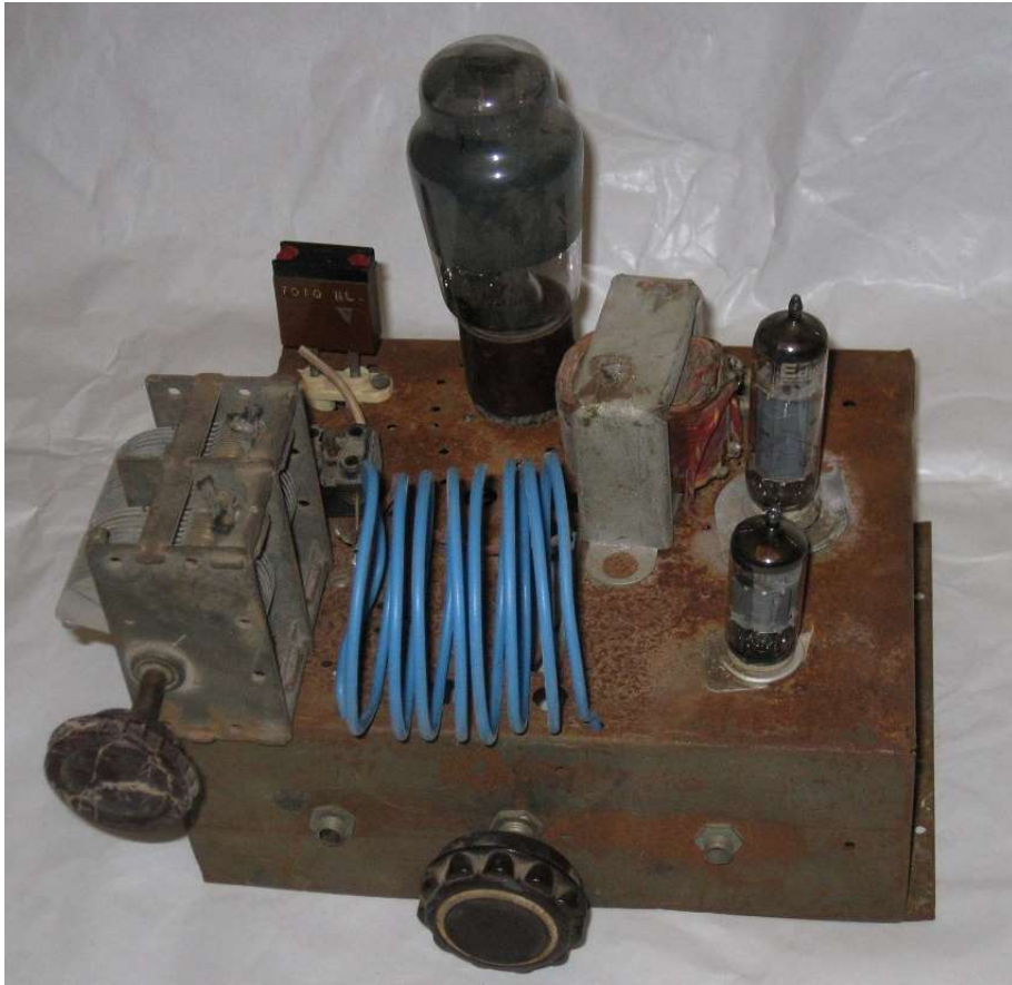
Recreación del aspecto, a falta de la fuente de alimentación, del micrófono y del manipulador de morse, de la emisora pionera de las primeras emisiones amateur en HF en Vila-real en 1970.
