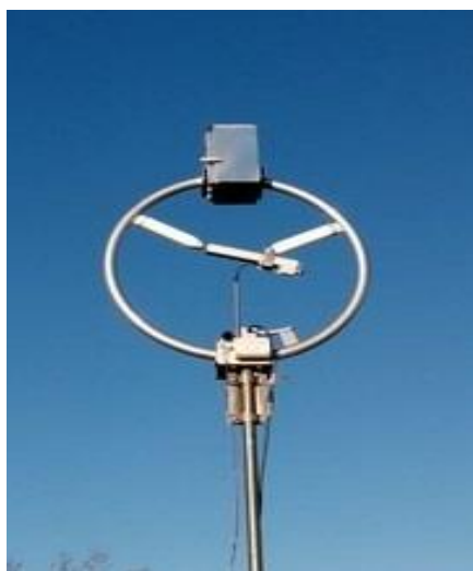
Antena modelo Baby de Ciro Mazzoni. Antena de aro que cubre las bandas de 10 a 20 metros en HF.
