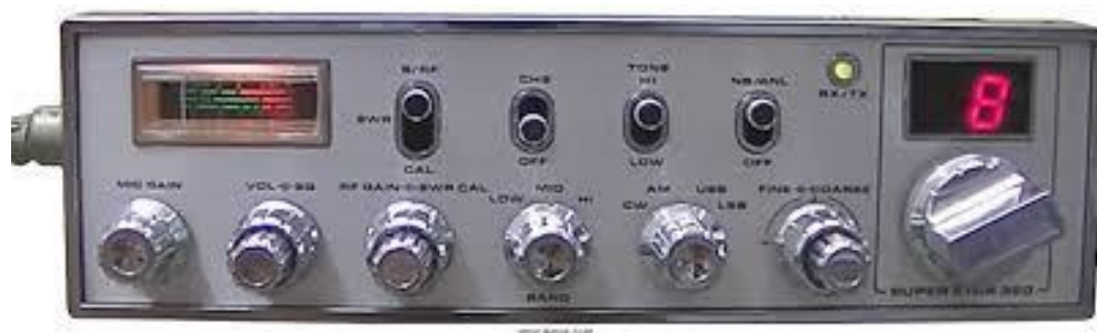
Imagen de una emisora Stalker Super Star 360, típica de los años 80 en CB con 120 canales AM/FM/CW SSB
