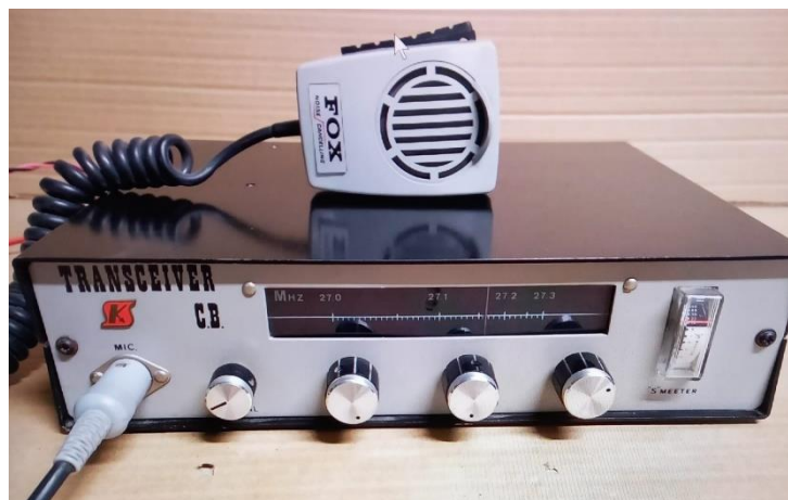
Imagen de una emisora de 27Mhz igual a la que montó Pablo en su Kit más avanzado (1979-80).
