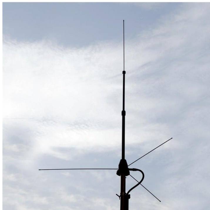
Antena de \frac{1}{4} de onda de VHF como la que tuvo instalada Polo EB5CUJ
