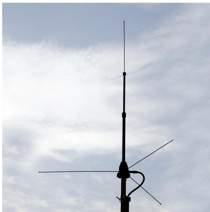
Imagen de una antena de 5/8 de onda de la banda de 144 mhz, similar a la que tenía instalada por Álvaro EB5AFW en los años 80.
