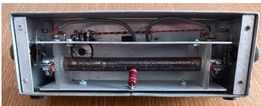
Imágenes del frontal y del interior del medidor de estacionarias. Construido por Domingo Gil EASTX
