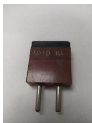
Cristal de cuarzo tallado a la frecuencia de 7.010 khz, como el usado por Domingo Gil EA5TX en sus inicios.
