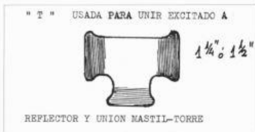
Figura 6: "T" usada para unir excitado a reflector y unión mástil-torre.
