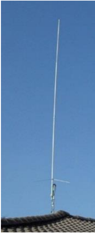
Izq. Imagen de una antena Diamon 510N para las bandas de V-UHF.
