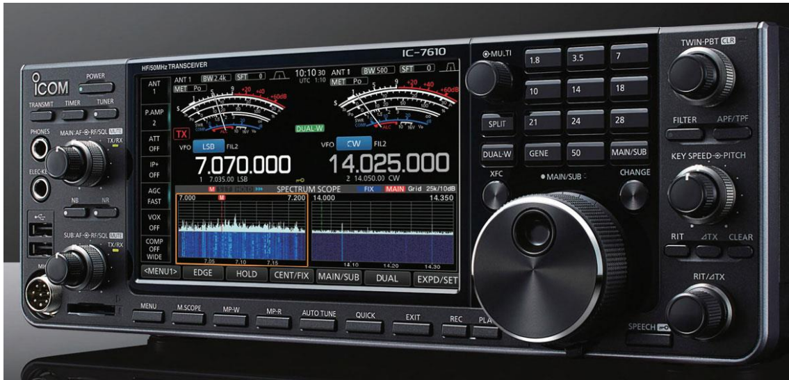
Majestuosa imagen de un transceptor ICOM 7610, toda banda con doble receptor SDR.
