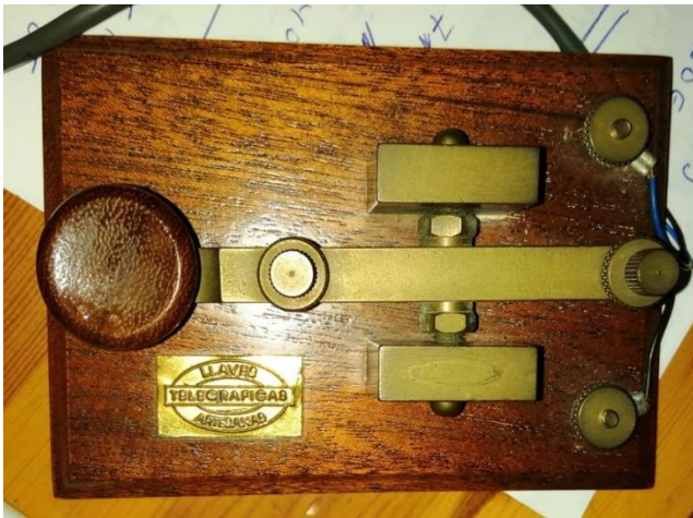
Izquierda: Manipulador de morse, instrumento de batalla de Rogelio García EA5HHL (aka EC5CJA )
