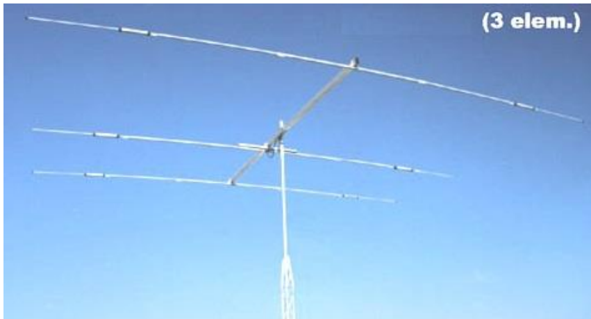
Antena direccional yagi de 3 elementos como la que instaló José Ezequiel EASEQH en su QTH de Lucena.
