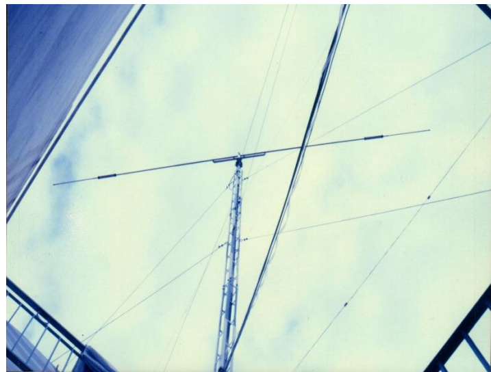
Antena Dipolo Rígido y dipolo trombón utilizados desde 1983 hasta 1990
