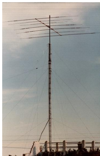
Antena TH7DXX y antenas de hilos terminadas. (1988-1992)
