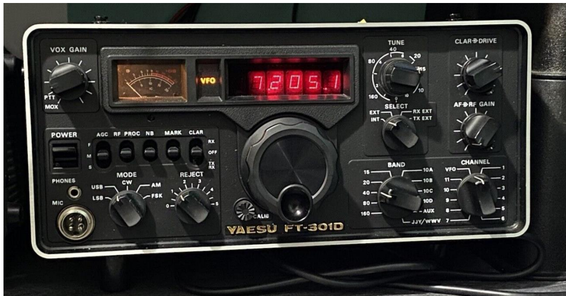
Transceiver Yaesu FT-301D totalmente transistorizado, similar al que tuvo Isidro Aparici EA5BEG
