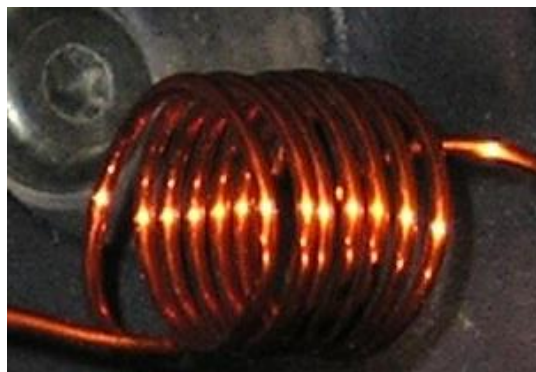
Ejemplo de bobina al aire. La que construyó Javier tendría unos 12cm de diámetro y unos 14 cm de largo
