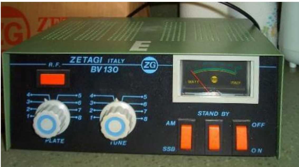
Imagen de amplificador lineal Zetagi modelo Bv130 como el que tuvo Javier Carda. Potencia aproximada 100 wsatts
