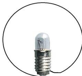
Imagen de lo que sería un aro de Hertz, captador de RF por inducción utilizado para ajustar la salida de la señal.
