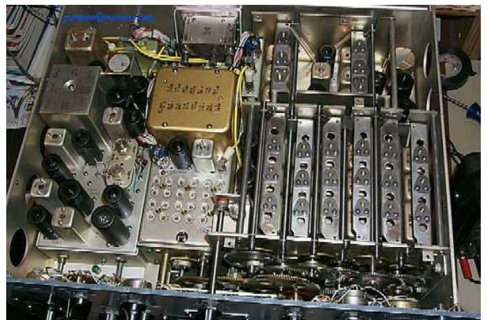
Izq. Vista frontal del Collins R390A/U Dcha. Vista interior del mismo equipo con un espectacular sistema de engranajes para mover arriba y abajo los botes de las bobinas de los circuitos de sintonía.
