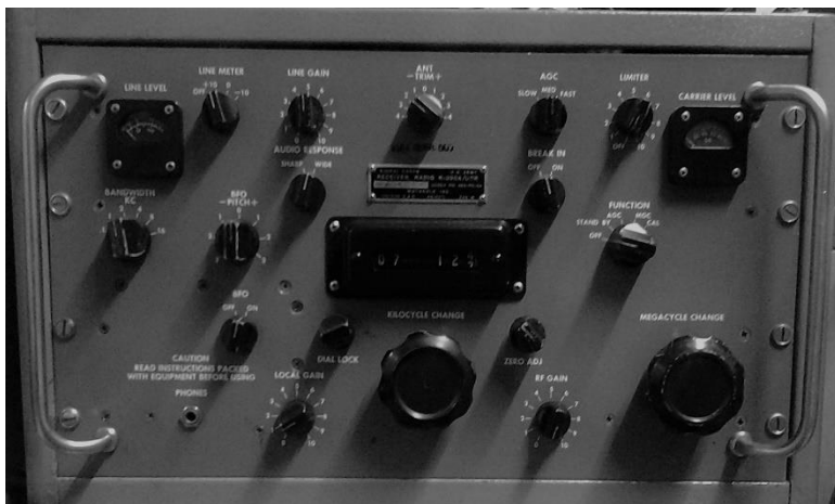
Izq. Vista frontal del Collins R390A/U Dcha. Vista interior del mismo equipo con un espectacular sistema de engranajes para mover arriba y abajo los botes de las bobinas de los circuitos de sintonía.
