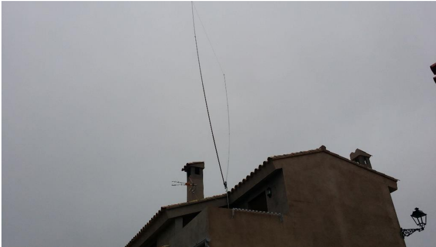
Antena delta loop invertida de José Albiol EA5TX, en su QTH de verano en Ludiente (CS)
