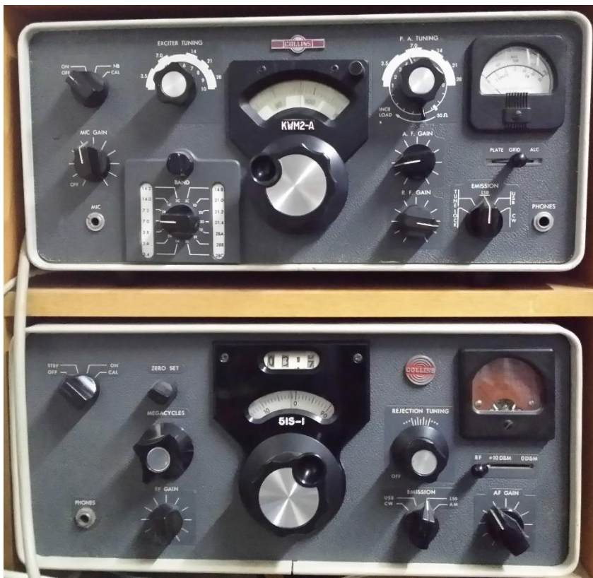
Arriba transceptor Collins KWM-2ª y abajo Receptor Collins 51S-1 propiedad de José Albiol EA5CF
