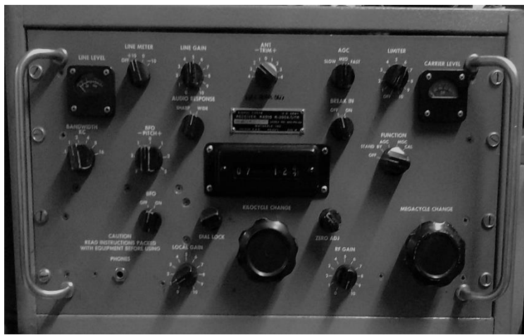
La joya de la Corona, a la izq. Frontal de Receptor Collins R-390-A/U y a la derecha interior del mismo receptor, donde se aprecian los mecanismos de engranajes que mueven las bobinas modulares. Un trabajo de artesanía de relojero suizo aplicada a un receptor militar. Propiedad de José Albiol EA5CF
