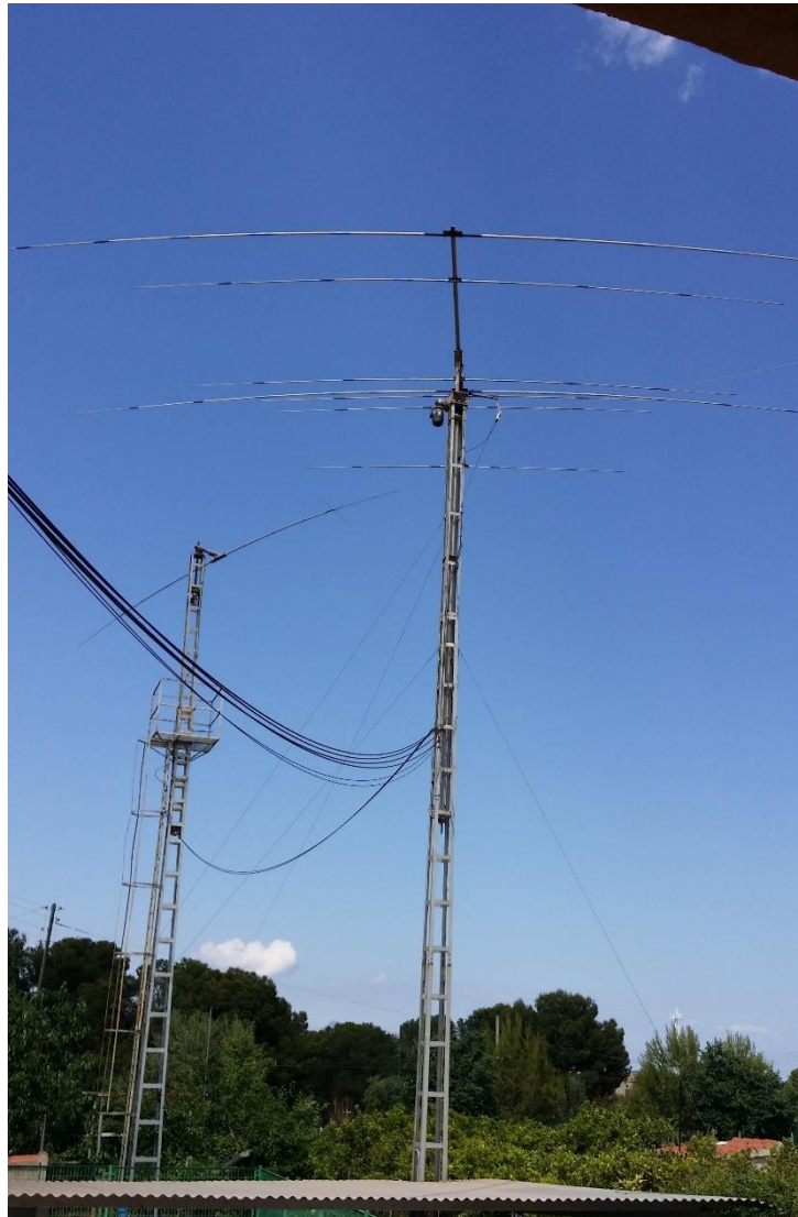
En primer plano direccional Force 12 y al fondo direccional (ahora de 1 elemento) para 40 metros procedente de la modificación de la yagi 2 elementos. QTH de verano de EA5CF
