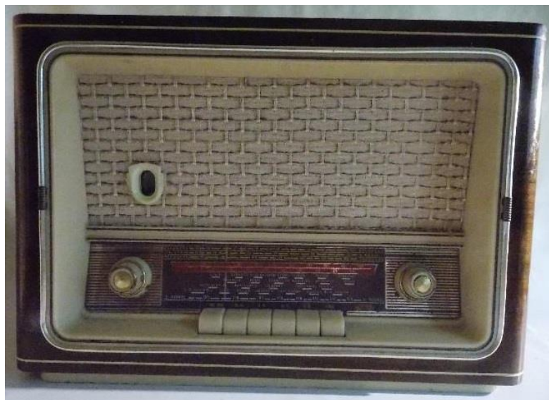
Modelo típico de radio musiquero que en aquellos años tenían todas las casas. Receptor a válvulas con OM/OC
