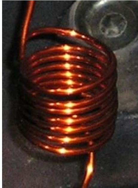
Bobina realizada con cable de cobre esmaltado con núcleo de aire.
