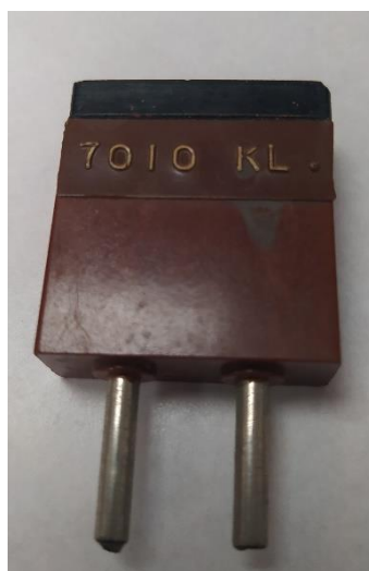
Cristal de cuarzo de la frecuencia exacta (7.010) que adquirió Pascual y sus amigos
