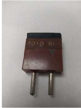
Imagen de un cristal de 7.010 khz similar al utilizado para construir aquel transmisor
