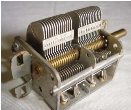
Izq. Condensador típico receptor musiquero. Dcha. Condensador variable de poca capacidad (el que hizo Paco tenía aún menos capacidad).
