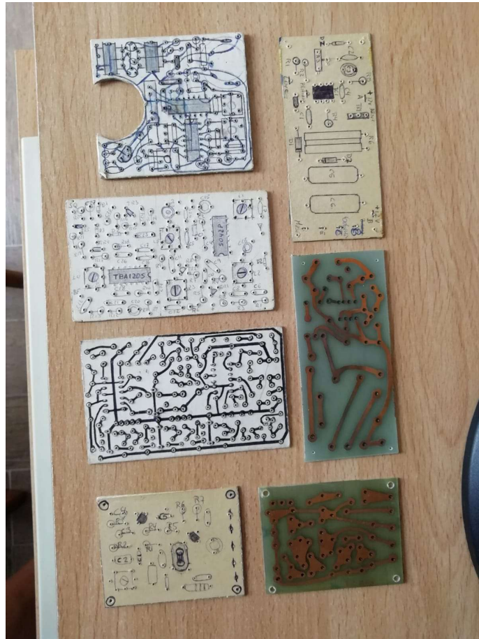
Creación de una placa de circuito impreso de forma artesanal. Ejemplo real de varios proyectos de Paco Ibañez EA5-1788-U
